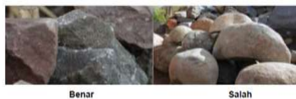
Gambar 11. Kulaitas batu kali/gunung yang baik digunakan sebagai pondasi
