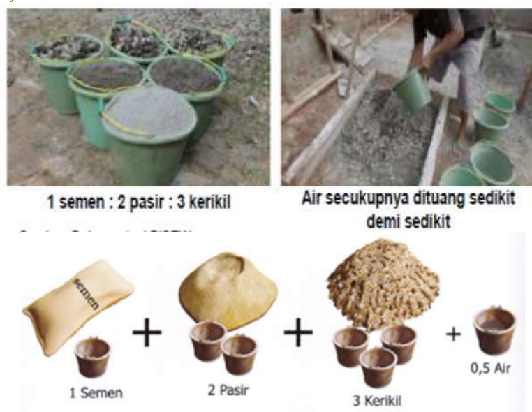
Gambar 6. Pencampuran beton
