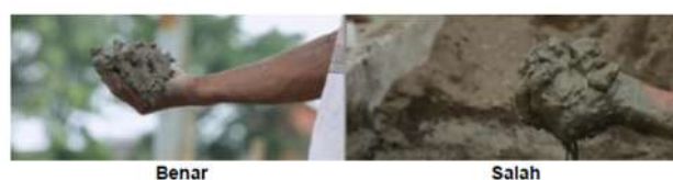
Gambar 7. Pengujian sederhana dengan meletakkan campuran beton di tangan
