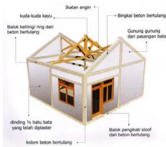
Gambar 5. Elemen struktur bangunan sederhana
