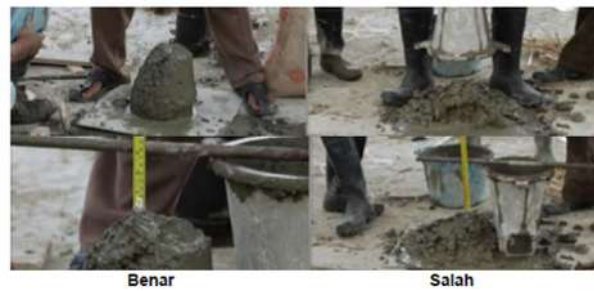
Gambar 8. Pengujian sederhana dengan menggunakan cetakan dan mengukur selisih ketinggian dengan cetakan
